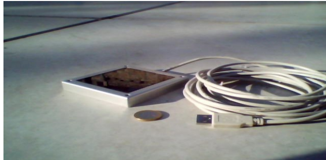
Abbildung 18: Der auf FINO 3 eingesetzte Beleuchtungsmesser im Größenvergleich zu einer Ein-Euro-Münze.
